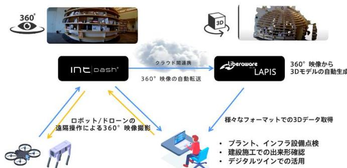
そのため、従来のワークフローに比べ、3Dデータ取得にかかる時間やコストが削減され、また、ロボット・ドローンの遠隔操作によるデータ収集が可能のため、狭所や危険エリアなど、人が入りにくい箇所でのデータ収集や、遠隔地からのデータ管理が可能となります。
