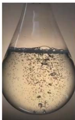
図1 ギ酸水溶液に触媒を加えると勢いよく水素ガスが発生
