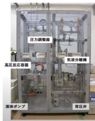
図2 産総研が技術実証に用いたギ酸による水素製造装置
