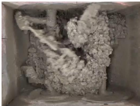
練り混ぜ中の生コンクリート
