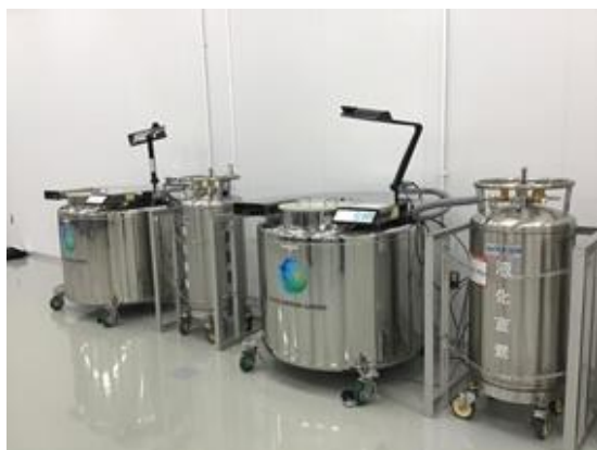
液体窒素を用いた貯蔵タンク
