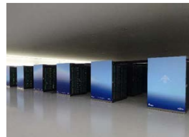
「富岳」を構成するコンピュータラック (提供元:理化学研究所)
