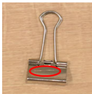
正常品に不良箇所（傷）を合成した例
