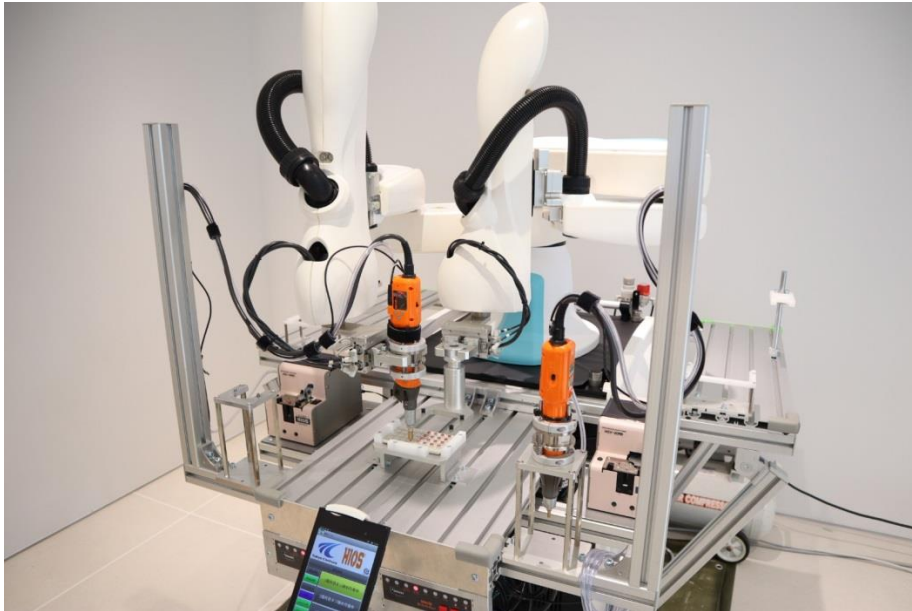
ハイオスの電動ドライバーを取り付けた人共存型双腕スカラロボット「duAro (デュアロ)」
