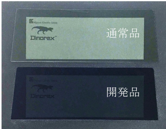
通常品（AR 未コート品）と開発品（ \text{Nb}_x\text{Ti}_{1-x}\text{O}_2 使用 AR 成膜品）の比較写真
