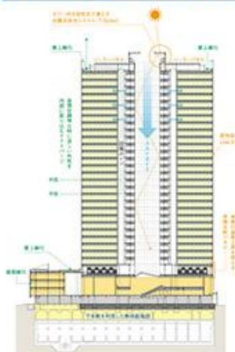
■自然光をビル内に導くスカイボイドや、涼しい外気を取り込むナイトパージなど、快適性と省エネルギー性能を高める設備を有する
