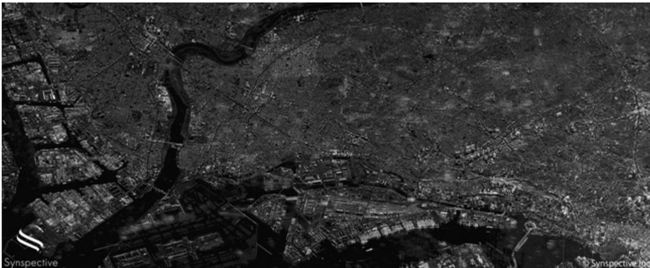
画像データを得るための衛星の撮像モードは、ストリップマップモード、スライディングスポットライトモード、ステアリングスポットライトモードの3種類です。ストリップマップモードでは、撮像幅及び撮像域（シーン）の長い画像を、グラウンドレンジ分解能3.5m×グラウンドアジマス分解能2.6mで撮像できます。スライディングスポットライトモードでは、アンテナビームをストリップマップモードより遅く走査させ、電磁パルスをより長い時間、地表の特定箇所に照射することでより高分解能な画像が取得でき、グラウンドレンジ分解能0.46m×グラウンドアジマス分解能0.5mで撮像できます。そして、ステアリングスポットライトモードは、より観測域を狭めて照射するモードで、グラウンドレンジ分解能0.46m×グラウンドアジマス分解能0.25mで撮像できます。
