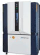
アスベスト(石綿)を使用した高度成長期の建物が耐用年数を迎えつつあります。その解体時のアスベスト含有調査に当社グループの製品が活躍しています。全自動多目的X線回折装置SmartLab SEは、特別な前処理を行うことなく低含有率のアスベストを検出することが可能です。
