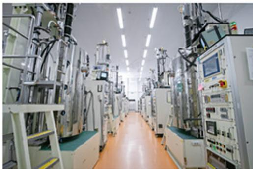
シンチレータ単結晶の製造装置
