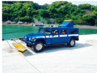
高速移動型非接触3Dレーダ探査車両
