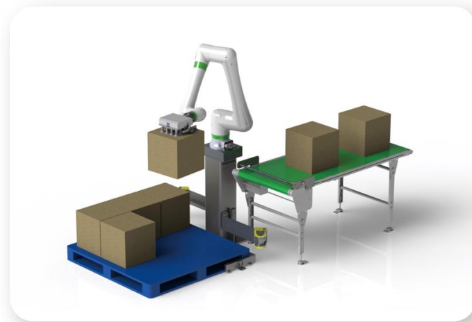
ロボットパレタイズシステム (パレット積み付け自動化)
