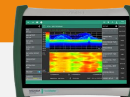
各種無線設備のフィールド検証用 多機能スペクトラムアナライザ MS2080A
