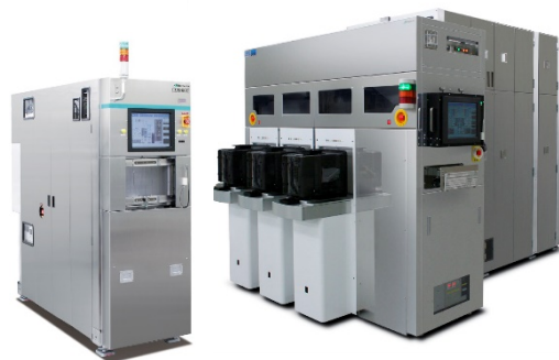
ケミカルドライエッチング装置 (CDE Series CDE-80,300)
