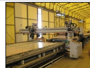
パネルシージングライン (自動釘打ちマシン)
