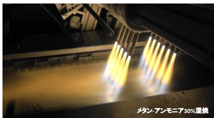
メタン・アンモニア30%混焼 工業炉におけるCO2排出量削減に貢献する アンモニア燃焼利用技術
