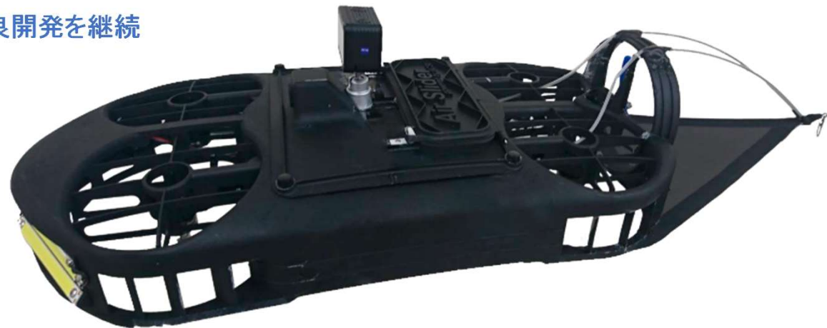
出典:NJS 水圧鉄管用に開発した機体
