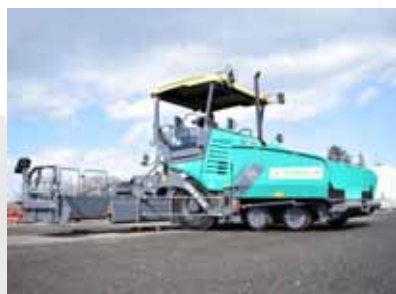
施工機械 (外国製大型アスファルトフィニッシャー)
