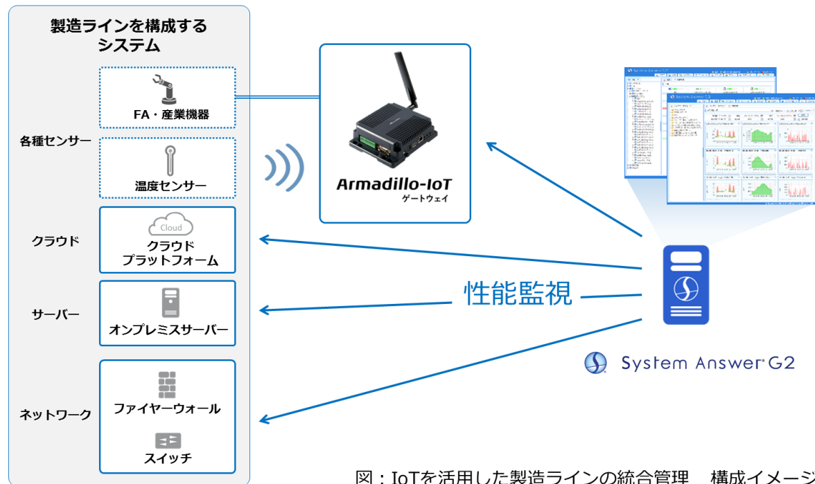
図：IoTを活用した製造ラインの統合管理 構成イメージ
