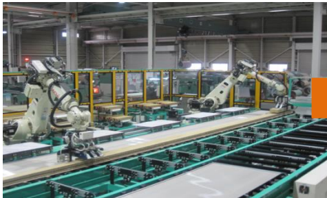
ロボットアームで耐火材を配置
