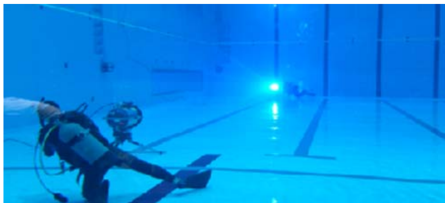
プールを使用した高速水中可視光通信装置の試験の様子
