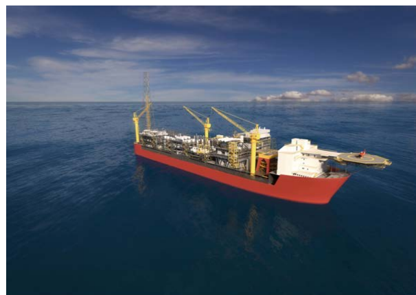
沖合生産・貯油出荷施設 (FPSO : Floating Production Storage & Offloading) 完成イメージ
