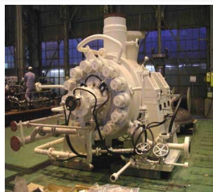
ボイラ給水用ポンプ
